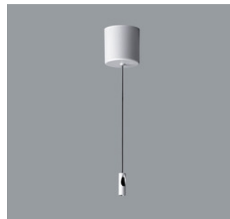
12662.000 Drahtseilabhangung Drahtseil: \varnothing 1,50mm, L 2500mm. Befestigungshule: Metall. Baldachin: Kunststoff, wei. \varnothing 65mm, H 63mm. Leitungseinfuhrung fur 3x1,5mm 2 Mantelleitung oder Wendelleitung. Zugentlastung. Anschlussklemme. Belastung 20kg. Nur in Verbindung mit 78671.000 79551.000 79556.000 79561.000 79566.000 79571.000
