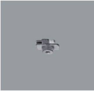
79530.000 Montage- teil für M5-Schrauben, mit Haltefeder. Aluminiumguss. Belastung 10kg.
