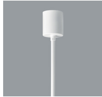
12446.000 Pendelrohrabhangung Pendelrohr: Metall, pulverbeschichtet. \varnothing 13mm, L 1040mm. Baldachin: Kunststoff. \varnothing 64mm, H 73mm. Belastung 20kg. Wei Nur in Verbindung mit 78671.000 79551.000 79556.000 79561.000 79566.000 79571.000
