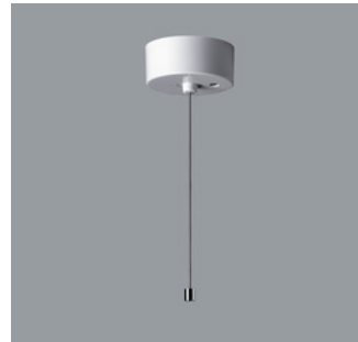
12671.000 Drahtseilabhangung Drahtseil: \varnothing 1,50mm, L 2500mm. Befestigungshule: Metall. Baldachin: Kunststoff, wei. \varnothing 105mm, H 43mm. Leitungseinfuhrung fur 5x1,5mm 2 Mantelleitung oder Wendelleitung. Zugentlastung. Anschlussklemme. Belastung 20kg. Nur in Verbindung mit 78671.000 79551.000 79556.000 79561.000 79566.000 79571.000
