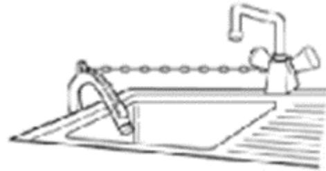
Ist das Gerät an ein eingebautes Abpumpsystem angeschlossen, prüfen, ob letzteres mit einem Lüftungsloch ausgestattet ist, um ein gleichzeitiges Zulaufen und Abpumpen von Wasser (Siphon – Effekt) zu vermeiden.
