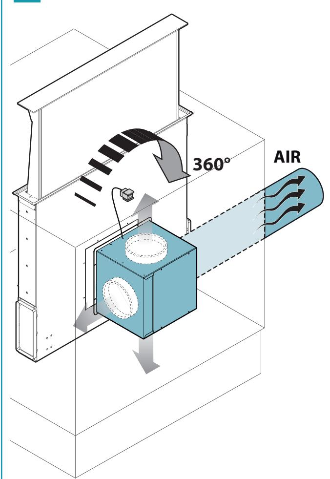
IT - Configurazione con motore remoto:
