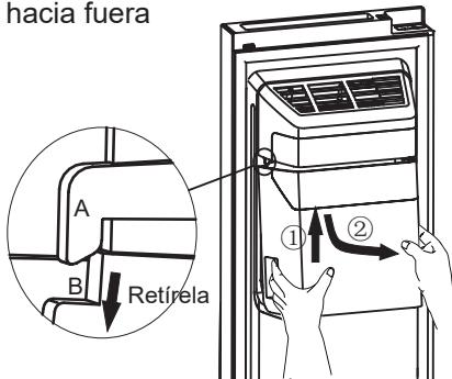
Cuando la coloque de nuevo, aseg rese de que ambos lados de la cubitera (B&B') est n bien colocados en sus gu as (A&A').
