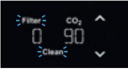
Wenn die Filterlaufzeit zu Ende oder eine Reinigung erforderlich ist, blinken die „Clean“- und „Filter“-Symbole. Das System muss gereinigt und ein neuer Filter eingesetzt werden.
