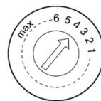
Nehmen Sie den Deckel des Klarspülmittelbehälters ab und drehen Sie den Wahlschalter in die gewünschte Stellung. Die Werkseinstellung ist "4".
