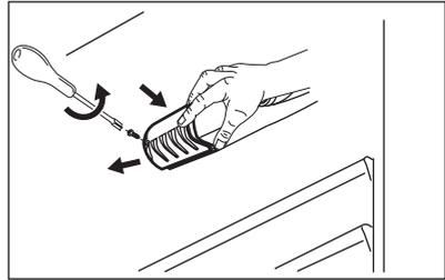
3. Ersetzen Sie die Lampe durch eine Lampe mit denselben Eigenschaften, die speziell für Haushaltsgeräte vorgesehen ist.
