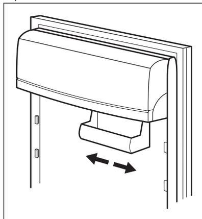
Questo modello è dotato di un contenitore a dimensione variabile per la conservazione che può essere spostato lateralmente.
