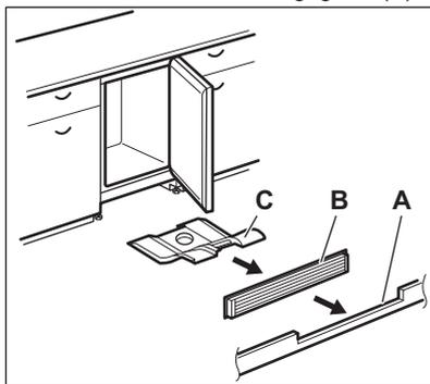
2. Reinigen Sie das Belüftungsgitter.
