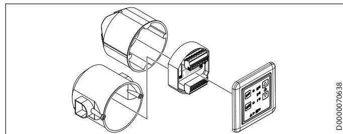
L'unità di comando e l'unità di programmazione vengono montate in una scatola da incasso. L'alimentatore viene montato su una guida DIN nella scatola dei fusibili. L'alimentatore e i morsetti in serie necessitano ciascuno di 4 posti nella scatola degli interruttori.
