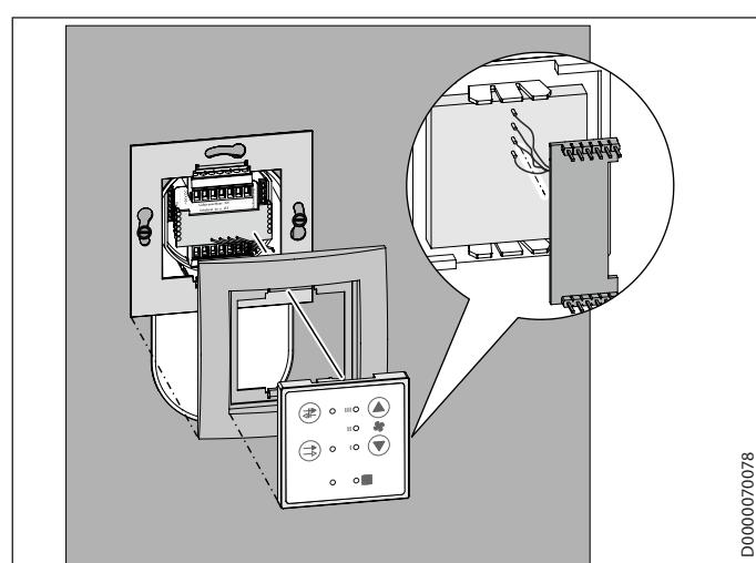
► Führen Sie die Adapterplatine durch den Abdeckrahmen und den Blechrahmen. Die kleinen Laschen zeigen später in die Wand hinein.
