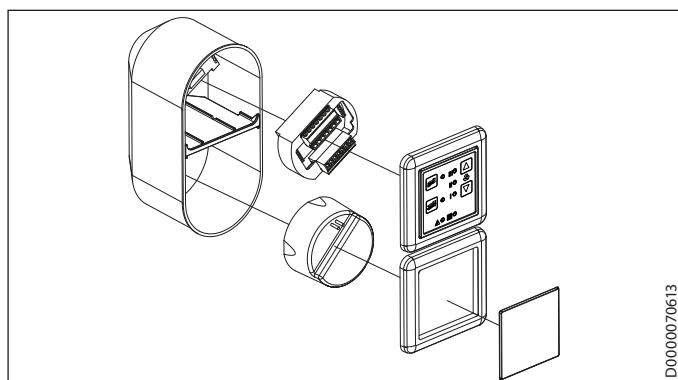
L'unità di comando, l'alimentatore e l'unità di programmazione vengono montati insieme in una scatola doppia da incasso.
