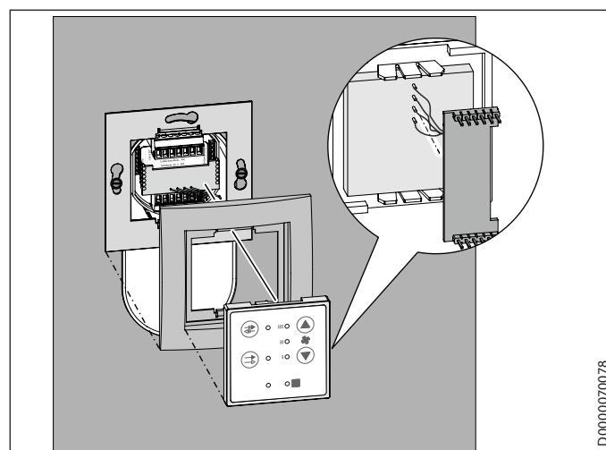
► Insérez la carte adaptatrice à travers le cadre de recouvrement et le cadre en tôle. À un stade ultérieur, les petites languettes pénétreront dans le mur.
