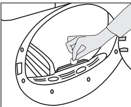
Ihr Trockner arbeitet mit Feuchtigkeitssensoren, um den Trocknungsgrad der Wäsche zu erkennen.
