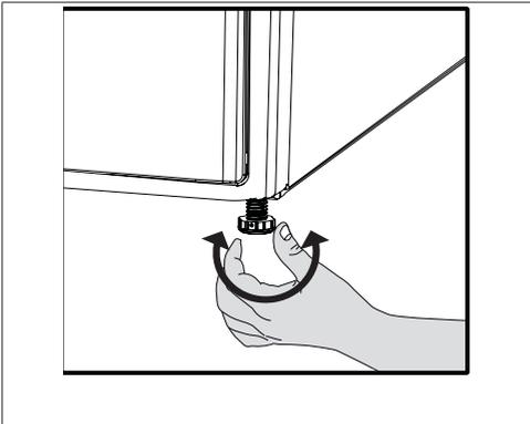
Stellen Sie die Füße (durch Drehen) so ein, dass der Trockner absolut gerade steht und nicht wackelt.
