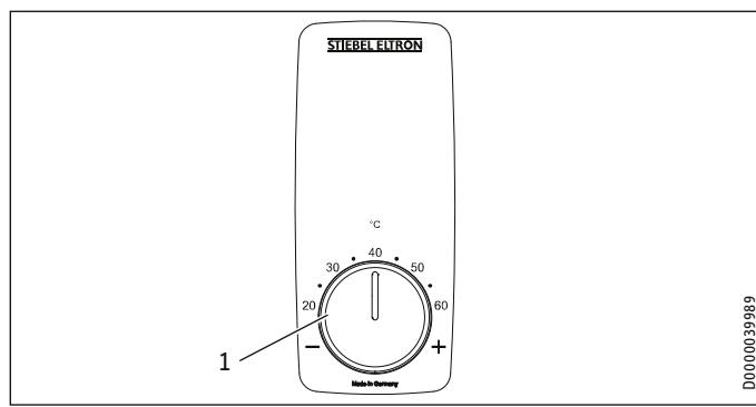
1 Nastavovací tlačítko teploty, nastavení teploty 20 °C - 60 °C
