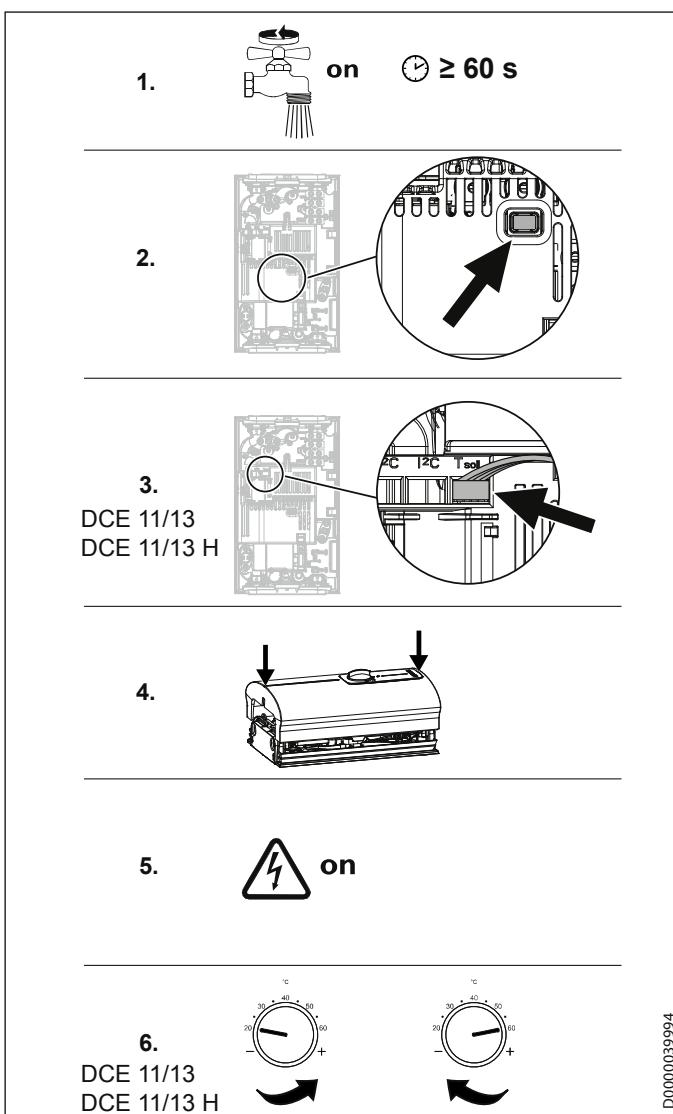
► Заполнить прибор, открывая и закрывая смеситель, пока из водопроводной сети и контура прибора не будет удален весь воздух. Несколько раз открыть раздаточный вентиль.
