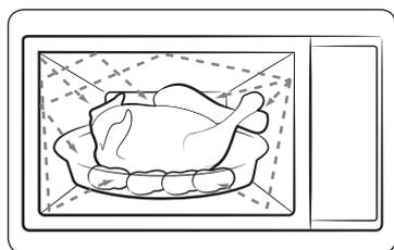
1. Die vom Magnetron erzeugten Mikrowellen werden im Innern des Garraums reflektiert und gleichmäßig verteilt, während sich die Speisen auf dem Drehteller drehen. So werden die Lebensmittel gleichmäßig erhitzt.
