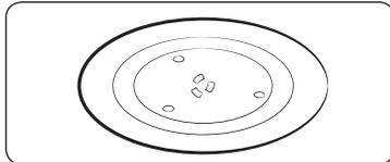
**02 Drehteller:** Muss so auf den Drehring gestellt werden, dass die Tellermitte auf den Drehaufsatz passt.
