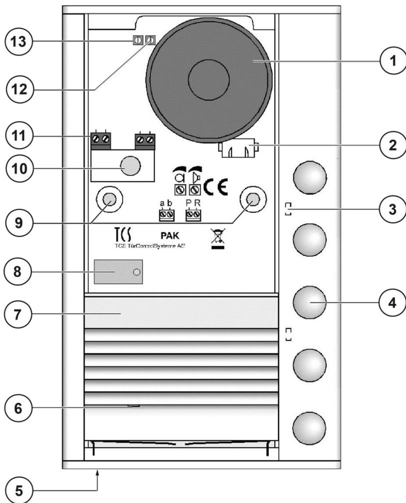
Abb. 1: PAK05-EN ohne Namensschildglas, Frontblende herunter geschoben
