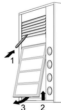
Abb. 2: Gehäuse öffnen
